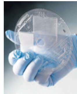
Laboratorio médico en un disco que utiliza microfluidos. IPHT
